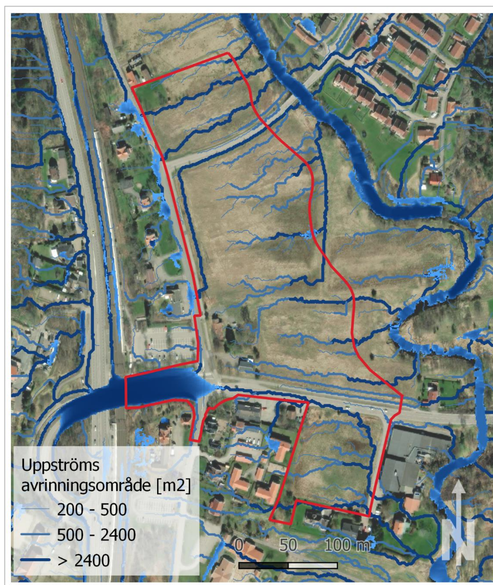
Figur 7. Ytliga rinnvägar och instängda områden. Flygfoto © Google (2023). Notera att vid den stora lågpunkten i viadukten finns en pumpstation som inte är med i genomförd analys, vilket innebär att vatten inte kommer att ställa sig i denna lågpunkt till den grad som visas i figuren.
