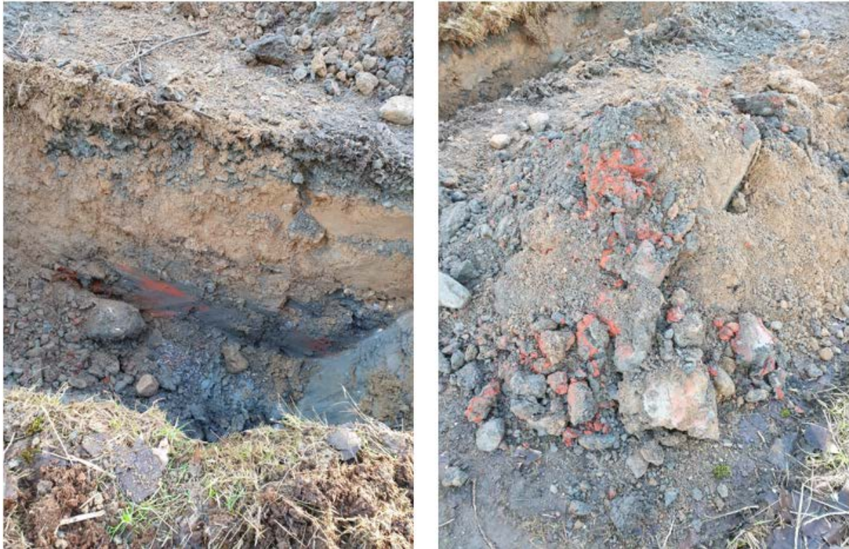
Figur 4. T.v. PG7 med inslag av rödmålarfärg på ca 0,6 meter djup. T.h. Den röda målarfärgen upptagen från PG7.
