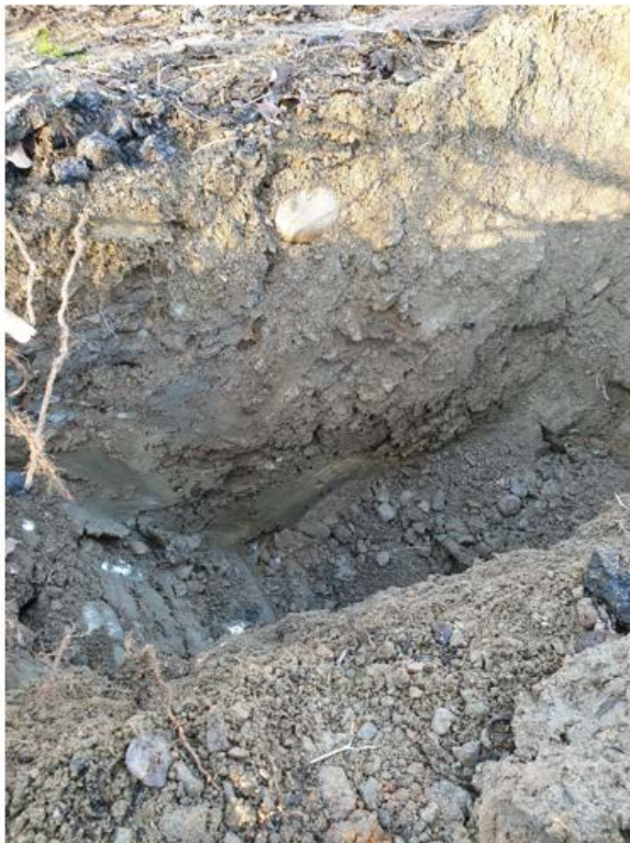
Figur 3 Fotot t.v. PG4 med fyllnadsmaterial av grusig stenig sand, som påträffades i flertalet gropar. Fotot t.h. PG10 med liknande material som i PG4 men med inslag av tegelrester.
