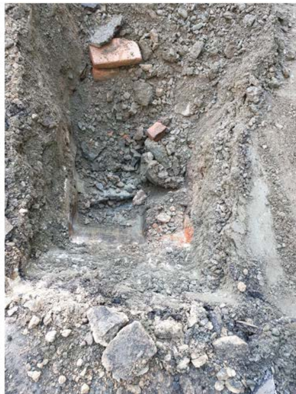
Figur 3 Fotot t.v. PG4 med fyllnadsmaterial av grusig stenig sand, som påträffades i flertalet gropar. Fotot t.h. PG10 med liknande material som i PG4 men med inslag av tegelrester.
