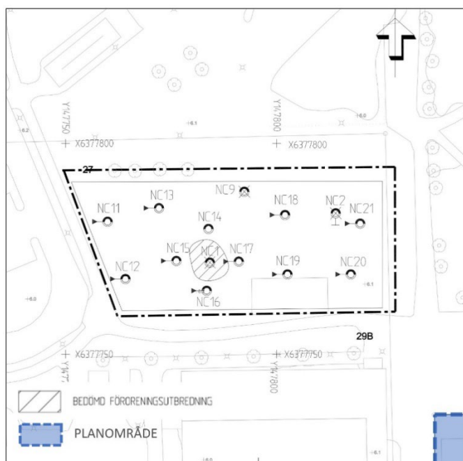
Figur 5. Från Kompletterande miljöteknisk markundersökning, Norconsult 2016-04-20. Figuren visar var en lokal förekomst av förorening i fyllnadsmassor påträffades och sanerades.
