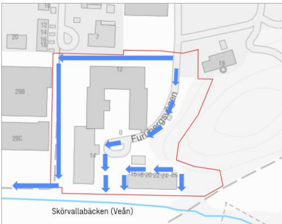
Figur 20. Förslag på hur skyfall kan avledas ytligt inom utredningsområdet vid kraftig nederbörd. Blå pilar visar ytlig avrinning.
