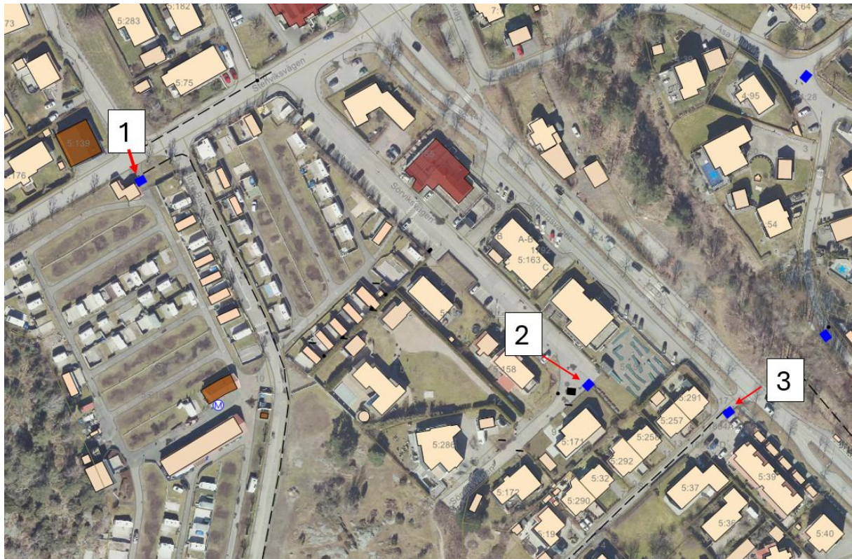
Figur 12 visar placeringen av befintliga brandposter i anslutning till planområdet. Numreringen hänvisar till kapacitetsangivelserna som följer: 1. Brandpost med kapacitet 20 liter per sekund (Stenviksvägen). 2. Brandpost med kapacitet 10 liter per sekund (Sörviksvägen) och 3. Brandpost med kapacitet 20 liter per sekund (Karlsviksvägen/Varbergsvägen).
