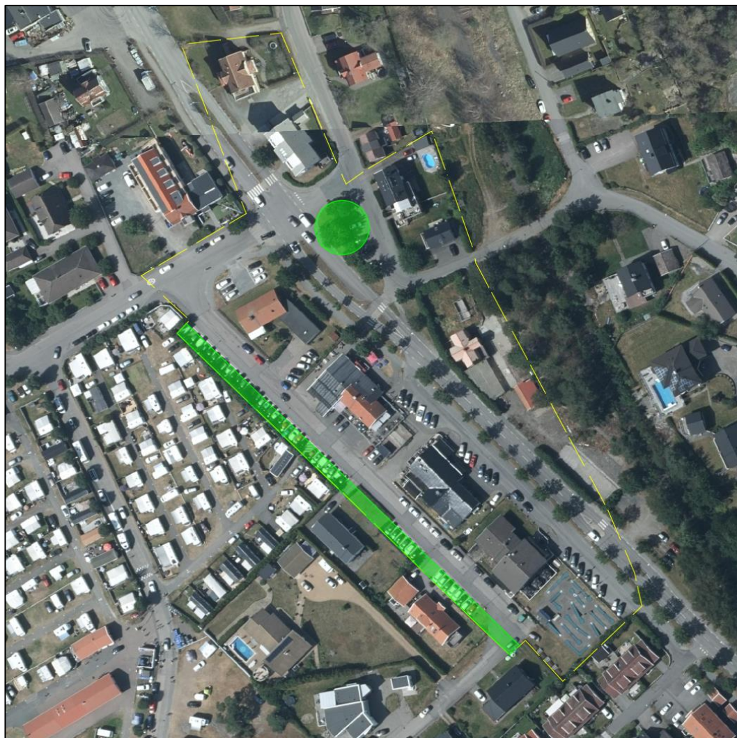
Figur 18. Förslag på placering och uppskattat markupptag av dagvattensystem vid ytliga lösningar och 100% hårdgöringsgrad.
