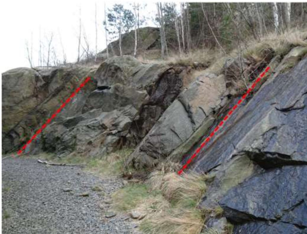
Figur 2 Foto av norra delen av bergsområdet inom planområdet. Foliationsparallella sprickor markerade med röd streckad linje, vy mot nordost.
