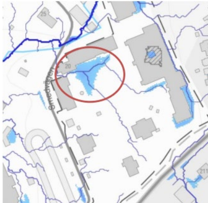
Bild 1. Skyfallsstråk illustrerat i befintlig bebyggelse visar hur ett instängt område (inringat i rött) riskerar att pressa vatten upp mot huskroppen.
