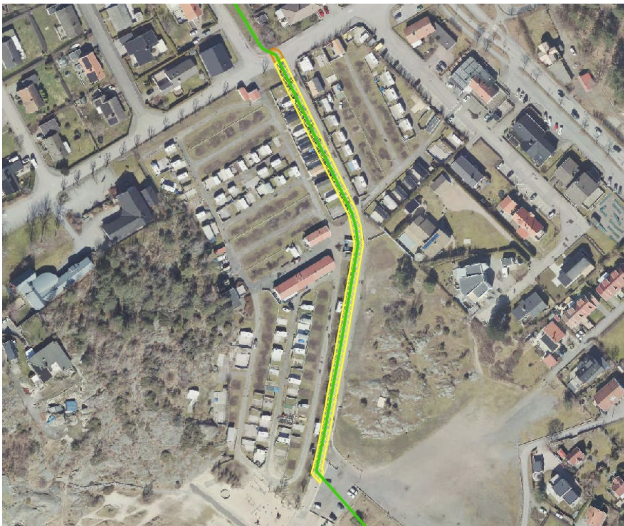
Bild 3. Markområden inom Åsa 5:6 (orange) och Åsa s:27 (gul) som kan vara aktuella att upplåta med ledningsrätt utanför detaljplanen. Grön linje är planerad ledningsdragning.
