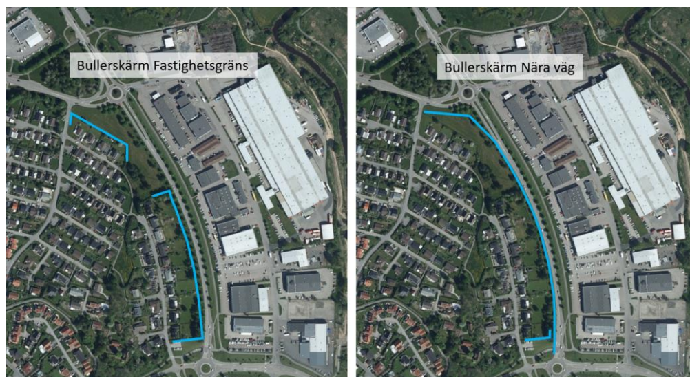
Figur 2. Placering av bullerskärmar
